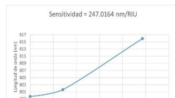
Figura 4. Sensibilidad del sensor 2 igual a 247.0164 nm/RIU.
