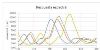
Figura 3. Respuesta espectral del sensor 2 operando a una longitud de onda de 791 nm y diámetro igual a 60 micrómetros.
